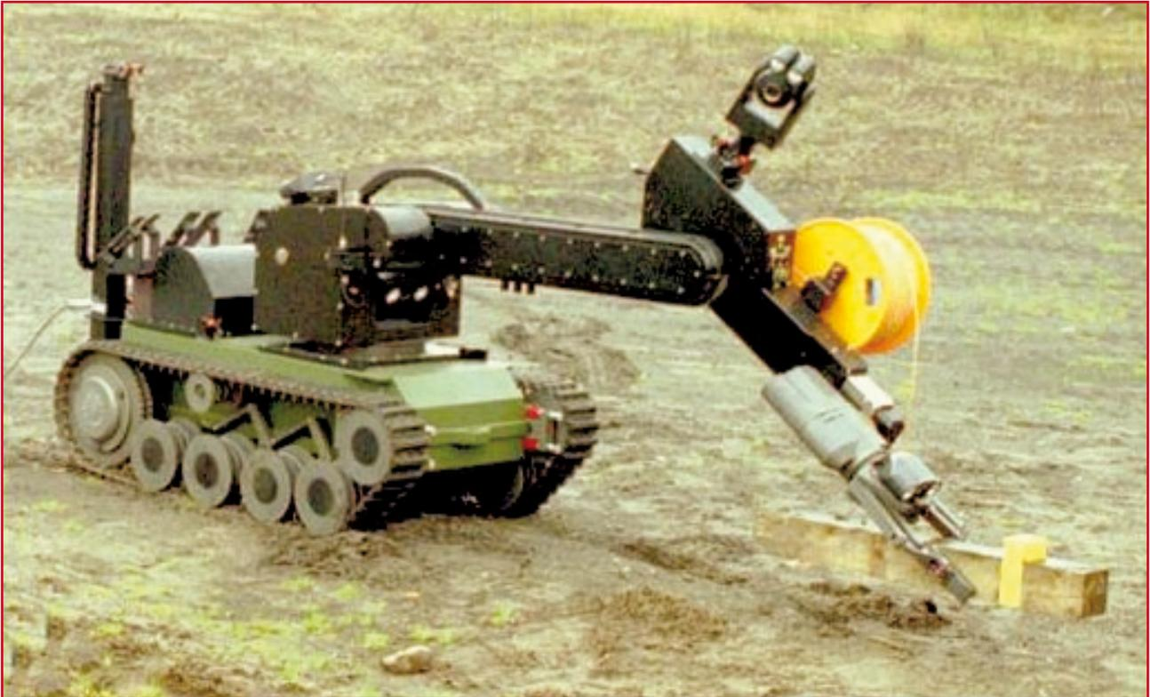
**Bild 40** Ferngesteuerter „Manipulator“ bei der Kampfmittelbeseitigung
